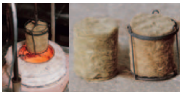
▲ Four de non combustibilité et laine de roche ROCKWOOL avant et après essai
